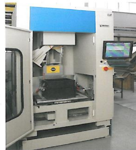
Roller Compactor – zagęszczanie próbek MMA
