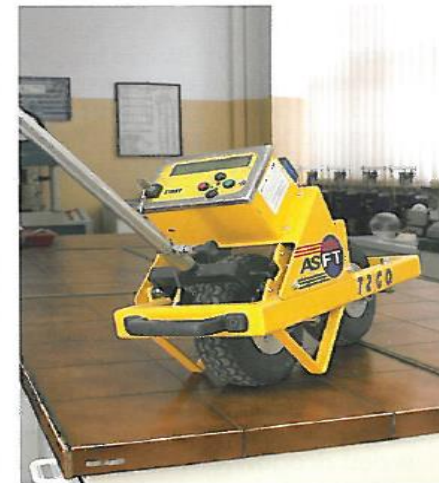
T2GO – badania właściwości przeciwpółzgowych nawierzchni drogowych
