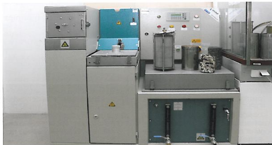
Ekstraktor ultradźwiękowy – badanie składu MMA
