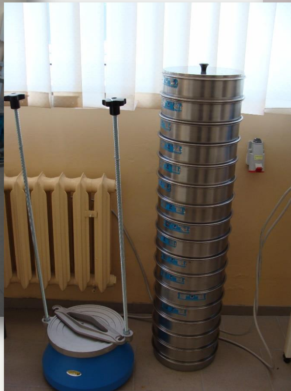
Wstrząsarka z zestawem sit do analizy sitowej kruszyw
