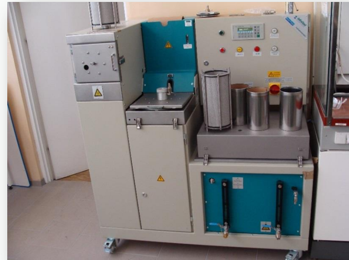
Ekstraktor ultradźwiękowy do badania składu MMA
