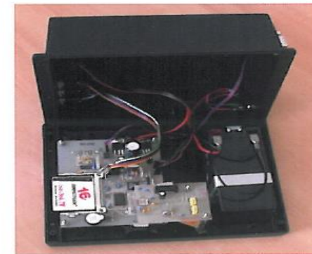
Przykłady aparatury badawczej do pomiaru cech geometrycznych drogi oraz charakterystyk ruchowych pojazdu
