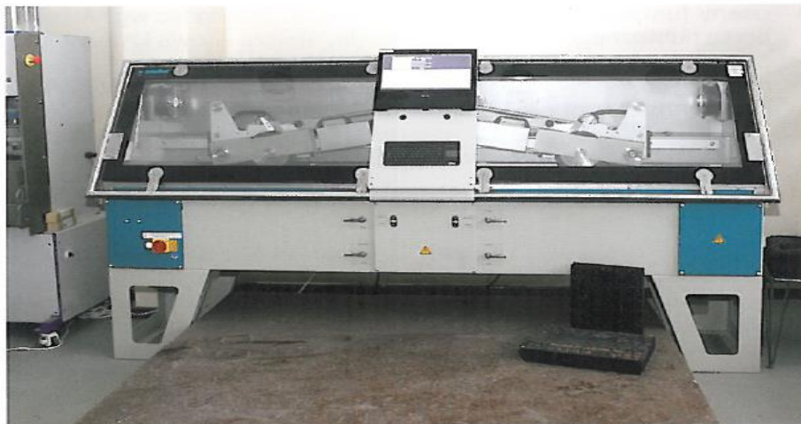
Koleinomierz – badanie odporności na odkształcenia lepkoplastyczne MMA
