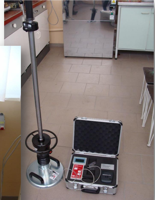
Płyta dynamiczna do badania zagęszczenia podłoża
