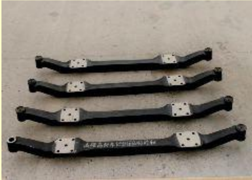
Przednie osie w samochodach ciężarowych (ponad pół miliona), wykonane ze stali bainitycznej
