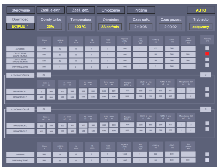
Rys. 15. Panel interfejsu operatora (opracowanie autora)
