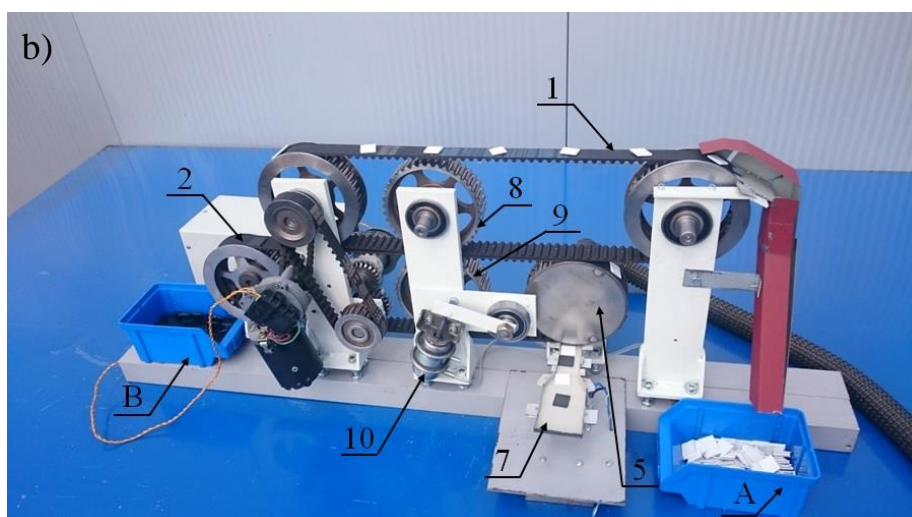
Rys. 5.1. Zmodernizowane stanowisko badawcze: a) rzut od strony układu rozdzielającego, b) rzut od strony podajnika, c) stanowisko wyposażone w układ grzewczy, 1 – górny pas separujący, 2 – dolny pas transportowy, 3 – otwory w pasie transportowym, 4 – przewód rurowy, 5 – walec zębaty, 6 – dozownik, 7 – podajnik wibracyjny, 8 - górne koło zębate, 9 – dolne koło zębate, 10 – siłownik pneumatyczny, 11 – tunelowy system grzewczy, konstrukcja własna
