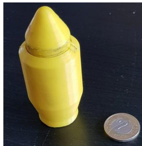
Rys. 7. Zdjęcie skonstruowanego zaworu (po lewej) oraz prototyp wydrukowanej dyszy osiowosymetrycznej z siłownikiem piezoelektrycznym (po prawej)
