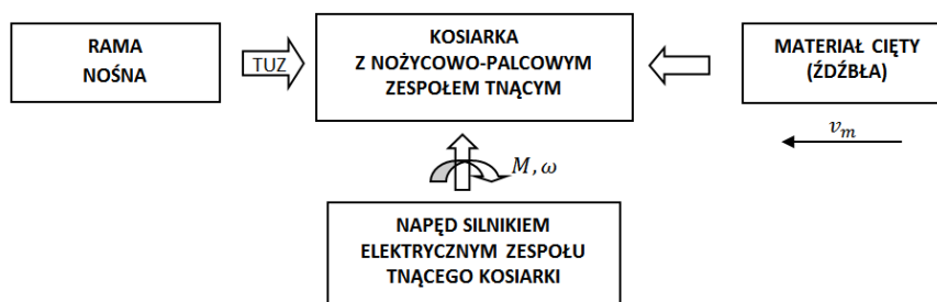
Rys. 36. Schemat blokowy stanowiska badawczego [opracowanie własne]
