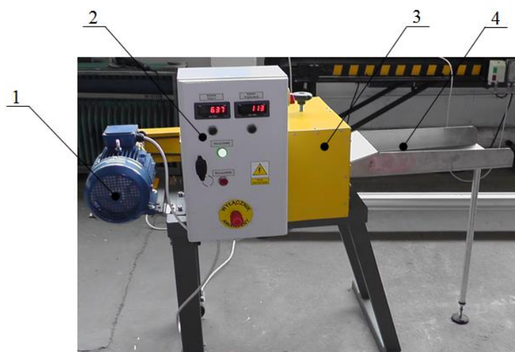
Rys. 41. Stanowisko do badań procesu cięcia bębnowym zespołem tnącym – widok z przodu [opracowanie własne habilitanta]: 1- silnik elektryczny z przekładnią pasową, 2-układ zasilająco-sterujący, 3-walce podająco-zgniatające, 4-rynna zasypowa
