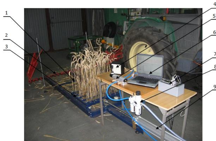
Rys. 35. Stanowisko badawcze – widok od strony stołu pomiarowego [opracowanie własne habilitanta]: 1 – źdźbła (materiał do cięcia), 2 – nożycowo-palcowy zespół tnący wyposażony w listwę nożową, 3 – wózek z materiałem do cięcia, 4 – stoper elektryczny, 5 – rozdzielacz pneumatyczny, 6 – komputer, 7 – miernik dwukanałowy MW2006-4, 8 – blok przygotowania sprężonego powietrza, 9 – siłownik pneumatyczny
