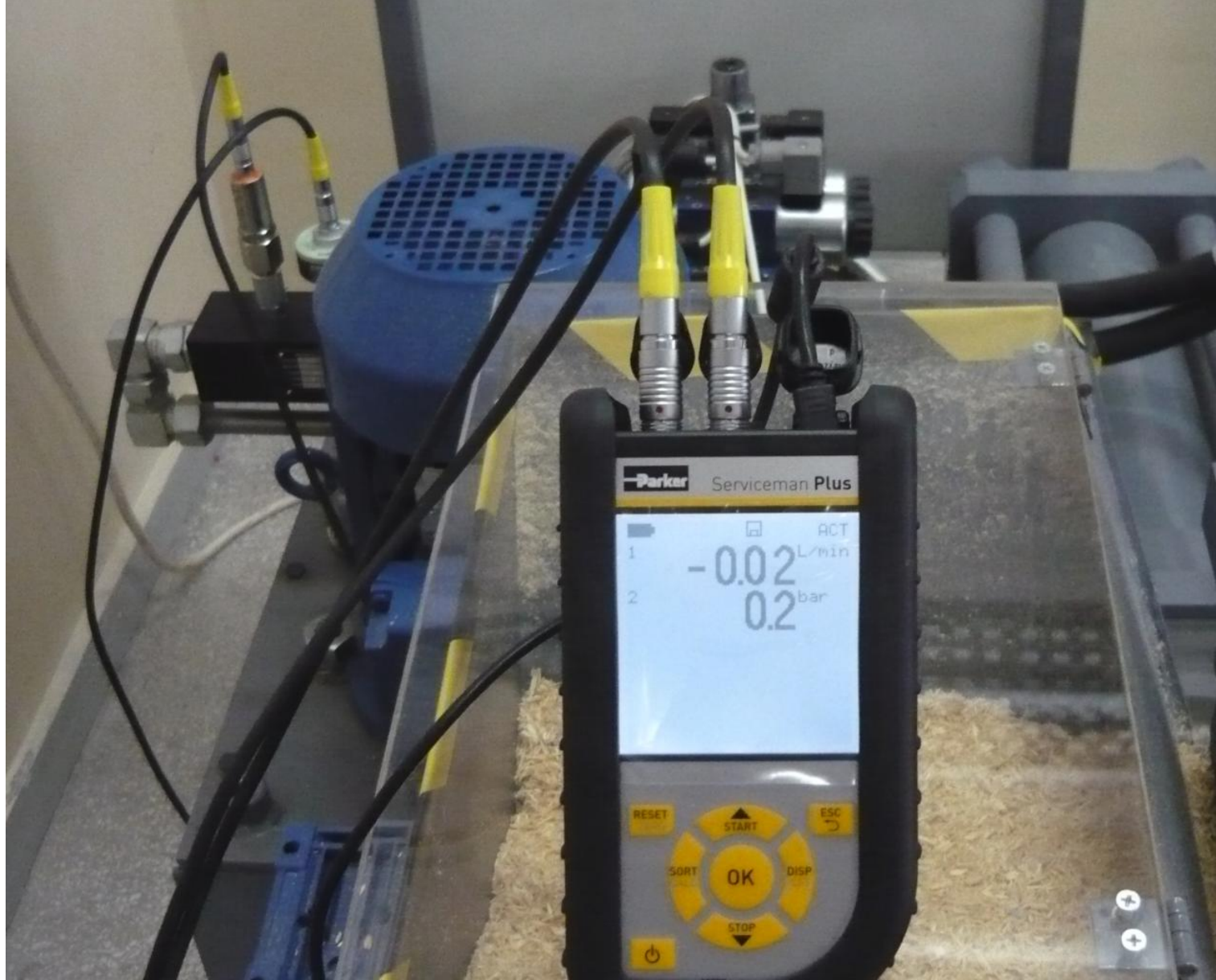
Przyrząd pomiarowy Serviceman Plus® model SCM-155-0-02 firmy PARKER
