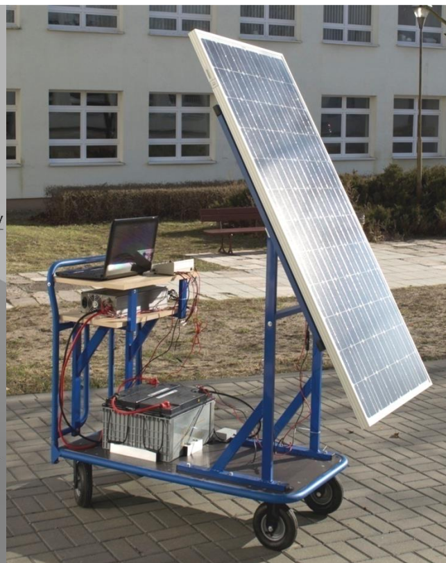
Model i wykonane stanowisko do badań instalacji PV
