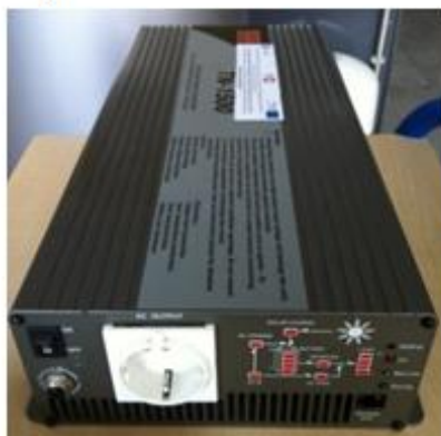
a) Inwerter MEAN WELL TN-1500, b) akumulatory żelowe 12V/100Ah, c) obciążenie aktywne
