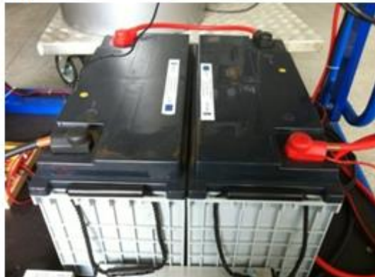
a) Inwerter MEAN WELL TN-1500, b) akumulatory żelowe 12V/100Ah, c) obciążenie aktywne
