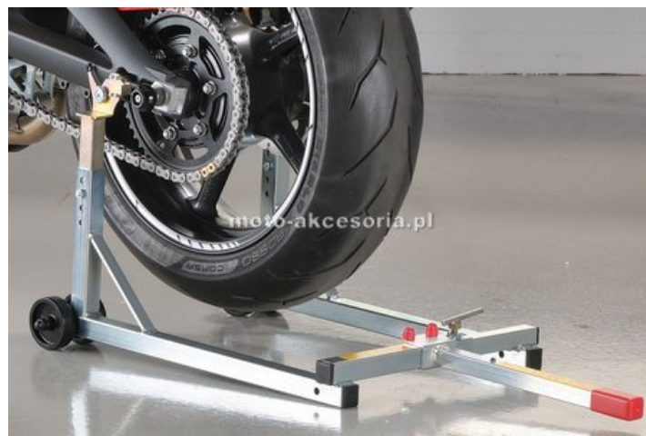
Rys. 2. Stojak motocyklowy uniwersalny [4] Fig. 2. Universal motorcycle stand example [4]
