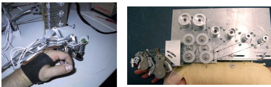
Rys. 2. Egzoszkielet Wege [8] oraz egzoszkielet CAFE [4] Fig. 2. Wege's egzoskeleton [8] and CAFE egzoskeleton [4]
