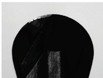
Rys. 2. Uszkodzony obszar na płaszczyźnie natarcia
